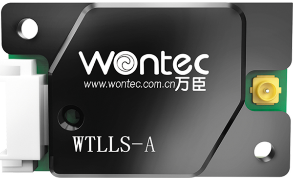
抗干扰液面传感器 WTLLS-A 抗干扰 ·抗干扰型电容式液面探测，常用于多针互相干扰的场合。
