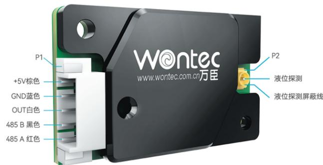
电路接线完成后，上电后LED指示灯快速闪烁一次，证明接线正确。
